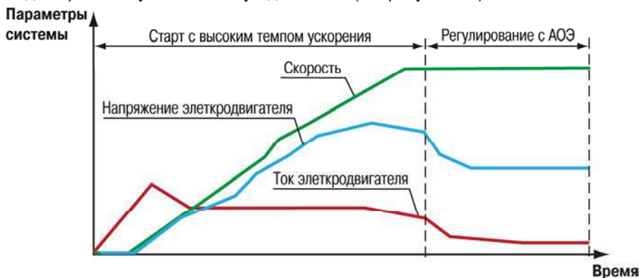
Рисунок 4.2 - Принцип работы оптимизации энергопотребления
